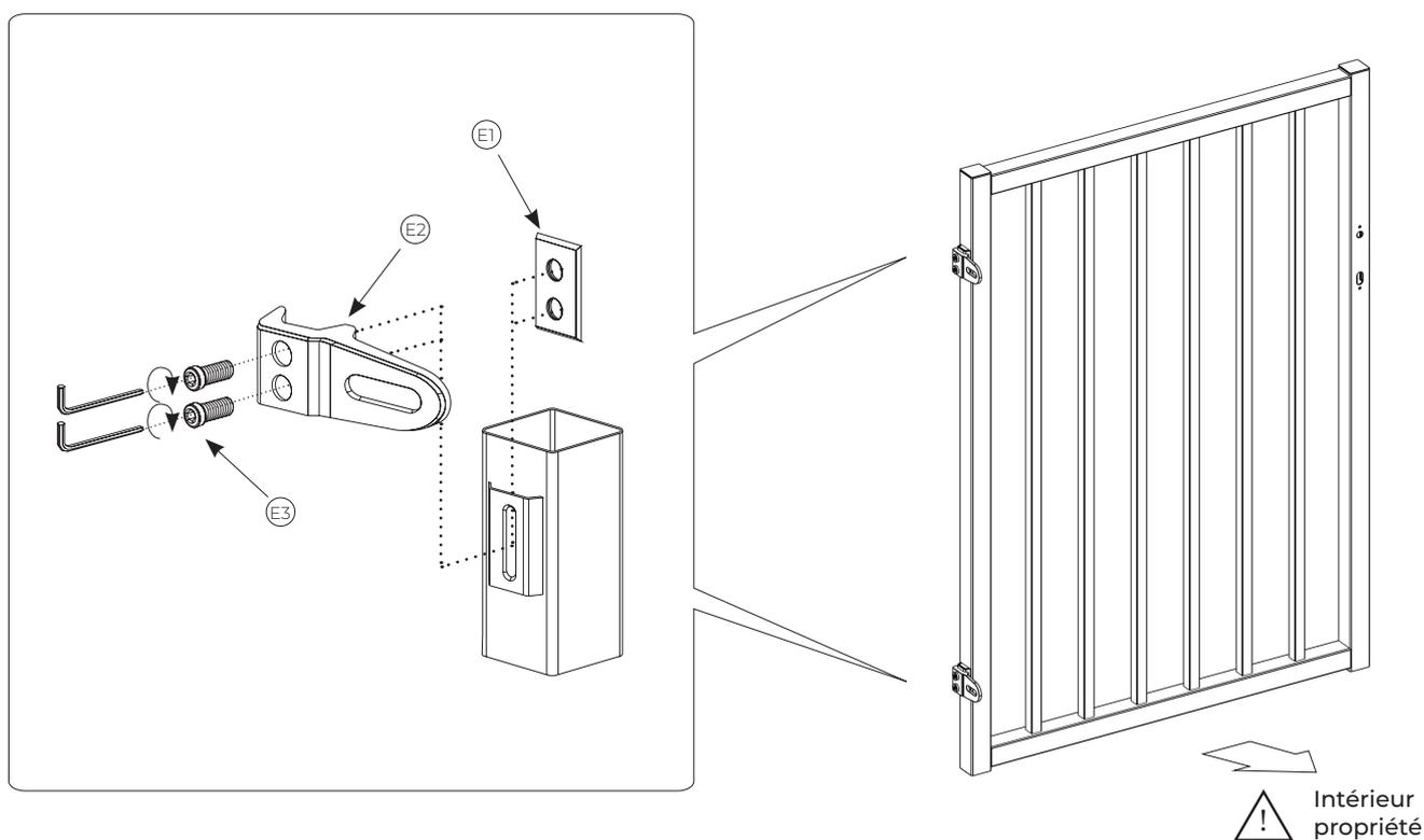
3. Reliez le vantail (B1) au pilier porteur (A2) en plaçant le boulon à œil (D2) à travers le grip (E2) du vantail comme indiqué ci-dessous.
