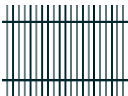
Modèle 1 : Barreaux dépassants
