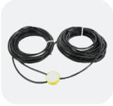
La boucle est un mécanisme à intégrer dans le sol à environ 5 cm de profondeur. Associée à un détecteur, tout véhicule se présentant dans le champ de détection déclenchera automatiquement l'ouverture du portail.
